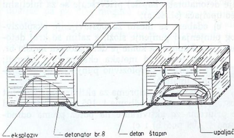
Sl. 42. Naoružavanje mine sa UDOP-1 na otpust, kada se upotrebljava detonirajući štapin
